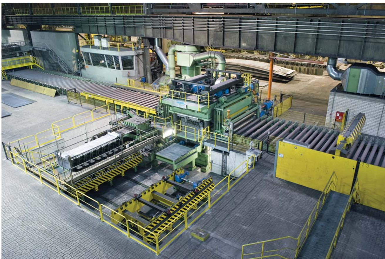
Рис. 1. Машина прецизионной правки в цехе завода компании ThyssenKrupp в Дуйсбурге
