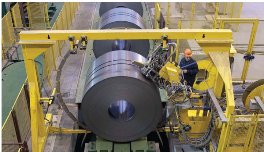
Рис. 4. Машина для обвязки рулонов по окружности
