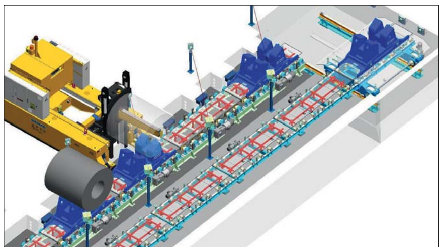
Рис. 3. Автоматизированная система транспортирования рулонов
