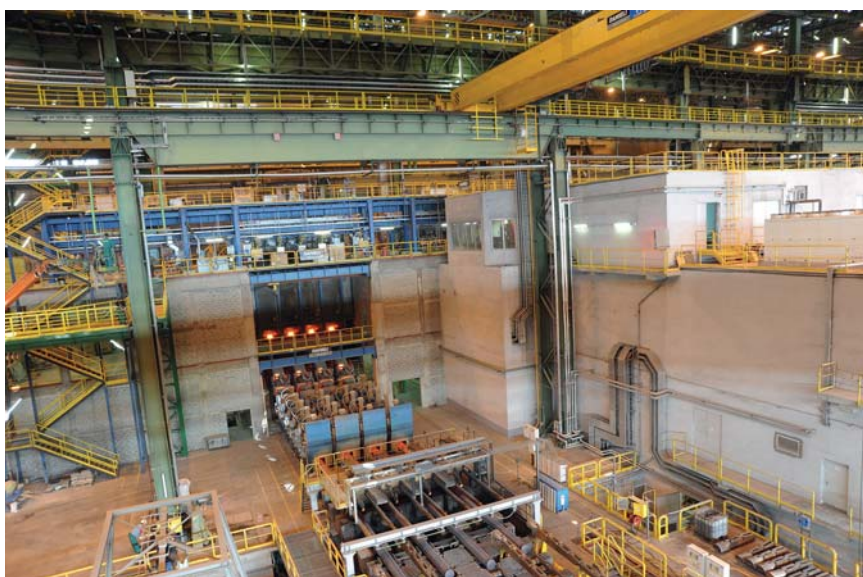
Рис. 5. Четырехручьева установка непрерывной разливки блюмов
