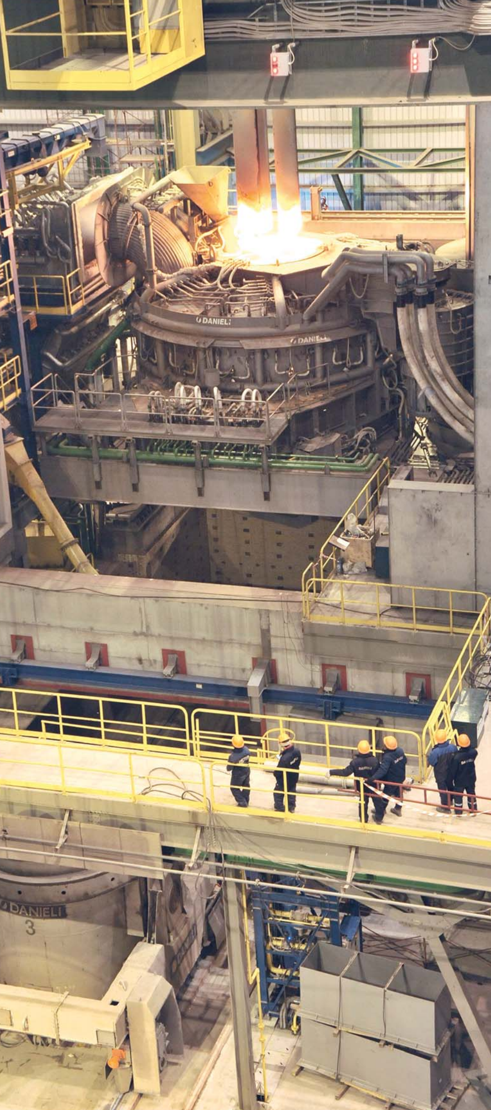
Рис. 6. 160-тонная электродуговая печь переменного тока, работающая на шихте из 100 % лома
