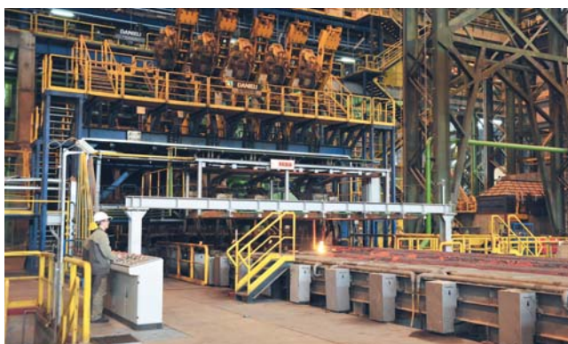
Рис. 8. Пятиручьева установка непрерывной разливки заготовок
