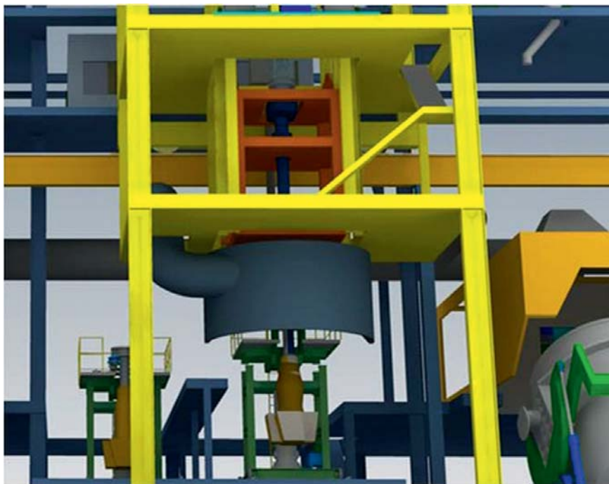
Рис. 3. Лопастное колесо для механического перемешивания и его опорная конструкция
