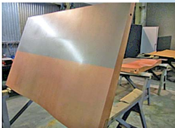
Рис. 1. Восстановление кристаллизаторов УНРС нанесением никелевого покрытия вошло в настоящее время в повседневную практику
