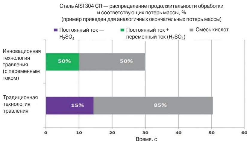
Рис. 2. Сравнительные показатели травления холоднокатаной полосы в рулонах из стали марки AISI 304 (продолжительность травления и потери массы, присутствие каждой технологии)
