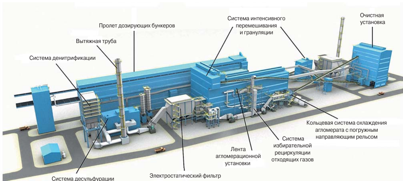
Рис. 3. Схема агломерационной машины, установленной на фабрике компании Dragon Steel Corporation
