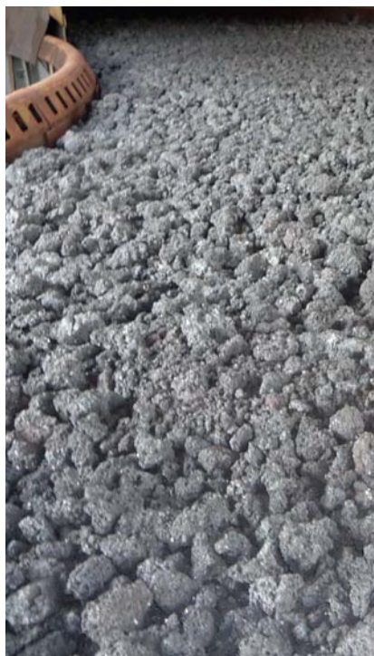
Рис. 5. Высококачественный охлажденный агломерат
