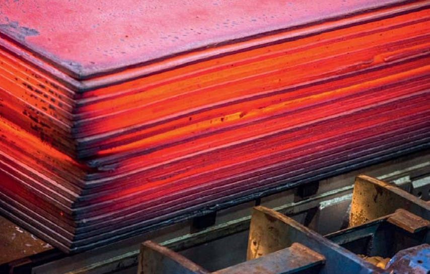
Стопа 9-метровых заготовок после отливки и резки на мерные длины летучими ножницами
