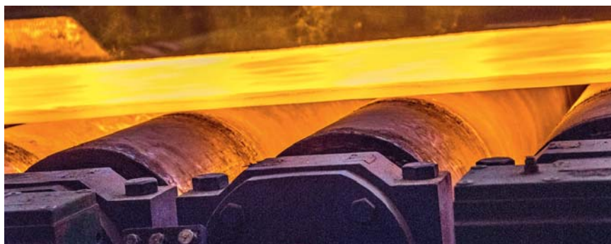
Горячая полоса на выходе из машины ленточного литья
