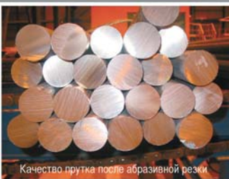
Качество прутка после абразивной резки
