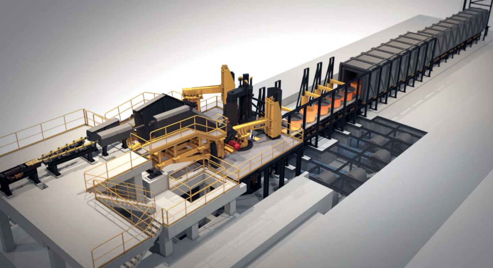
Типовая планировка линии отделки мелкосортного проката в бунтах
