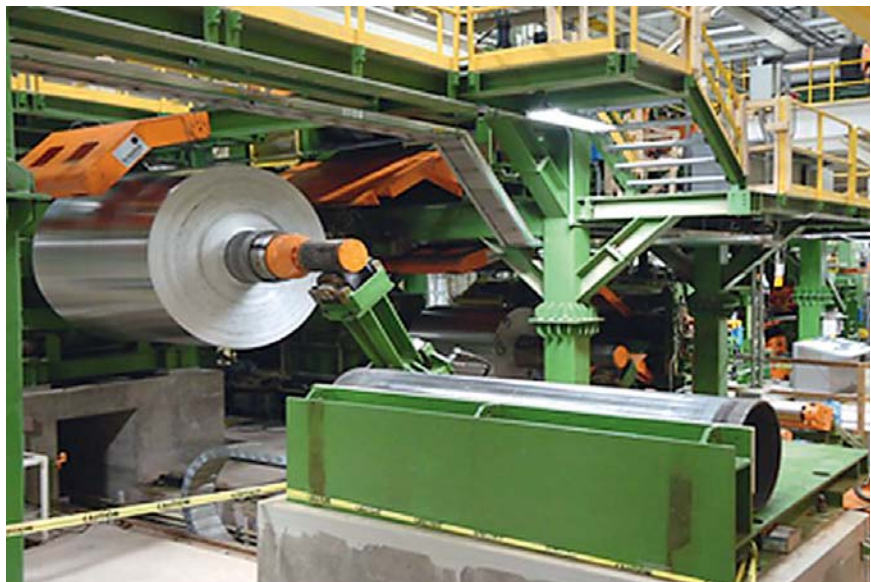
Входная сторона линии непрерывного отжига и поверхностного нагрева алюминиевой полосы, используемой в автомобилестроении
