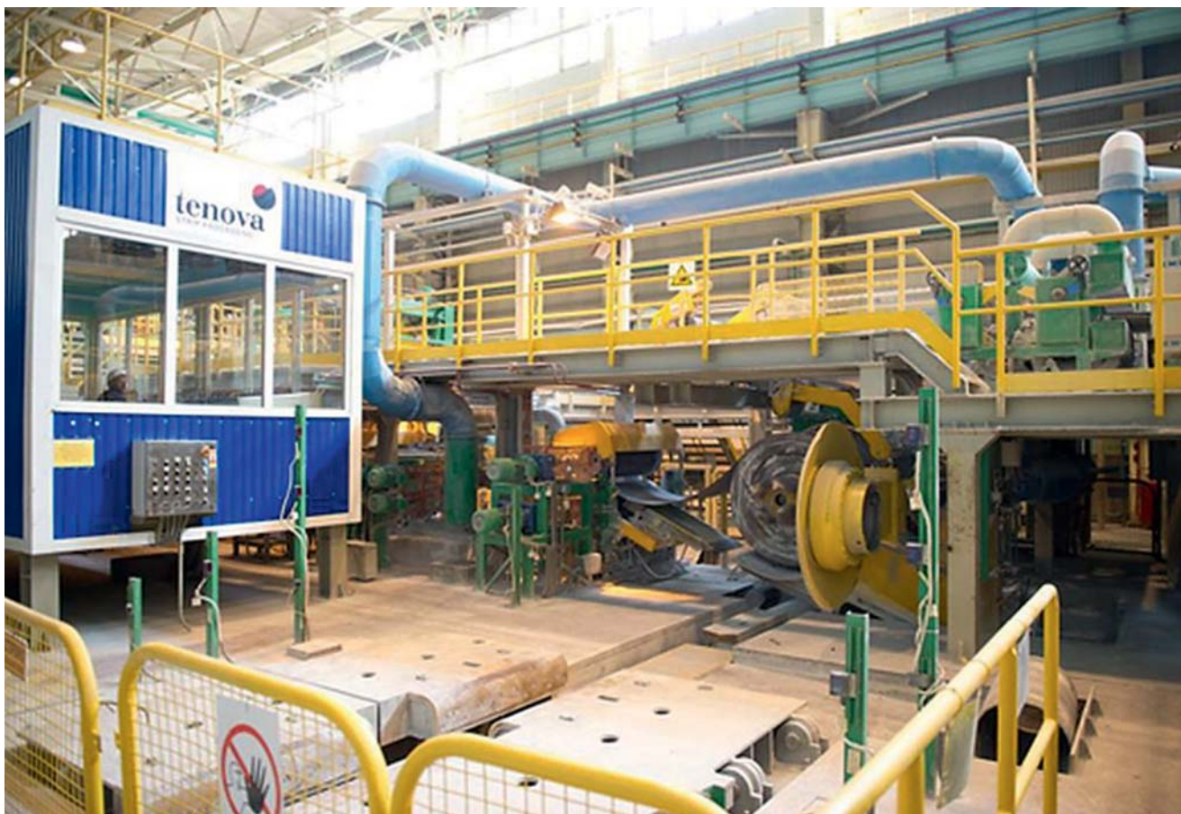
Входная сторона линии правки и нанесения покрытия на полосу из высококачественной кремнистой трансформаторной стали
