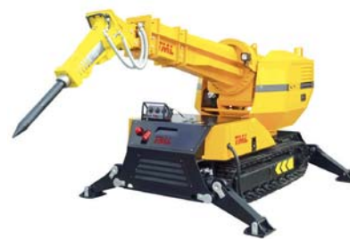
Новая установка для ломки футеровки UNIDACHS 220
