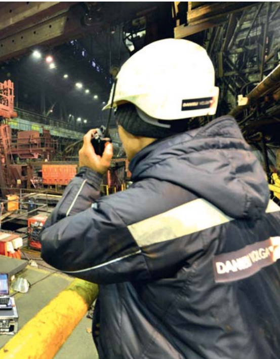
Определение пространственных координат прокатных клетей с целью установки базовых плоскостей для механической обработки
