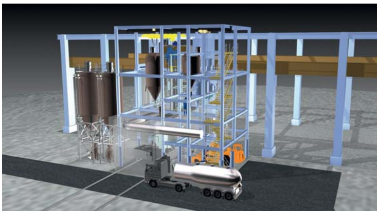
Участок предварительной обработки чугуна со сквозным проездом
