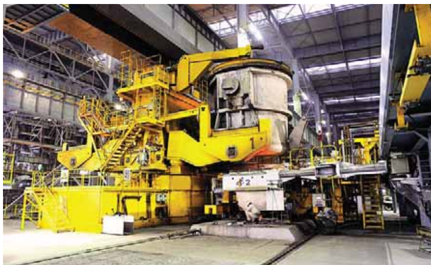
Рис. 6. Поворотная платформа для ковшей на заводе Baosteel № 4, Китай
