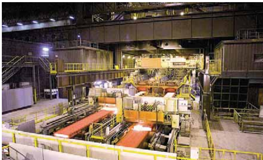
Рис. 5. Двухручьевая МНЛЗ на заводе фирмы Sollac в Дюнкерке, Франция, группа ArcelorMittal
