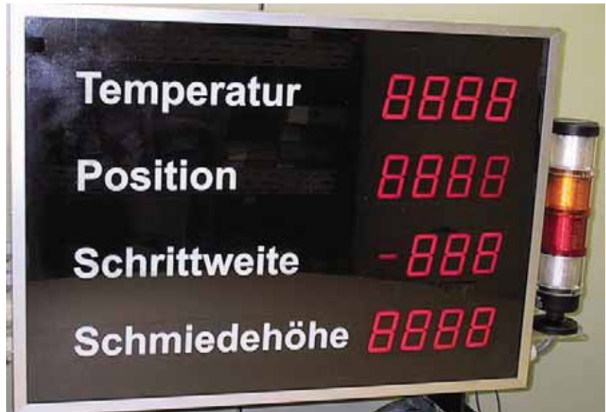
Сведения для оператора на индикаторе с большим дисплеем (сверху вниз): температура заготовки, положение манипулятора, величина шагового перемещения, высота ковки
