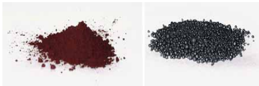
Рис. 1. Порошкообразный оксид, полученный на спреерной обжиговой установке (слева), и гранулированный оксид, полученный при обработке в псевдоожиженном слое
