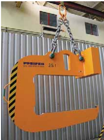
С-образный крюк для рулонов грузоподъемностью 25 т
