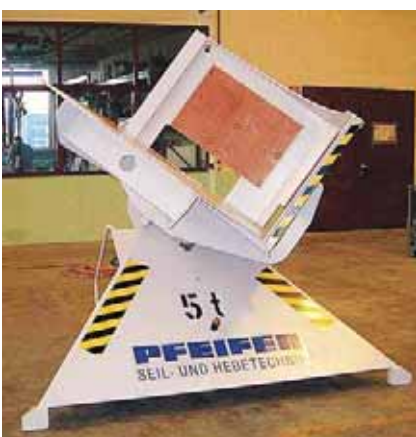
Поворотный стол для рулонов грузоподъемностью 5 т
