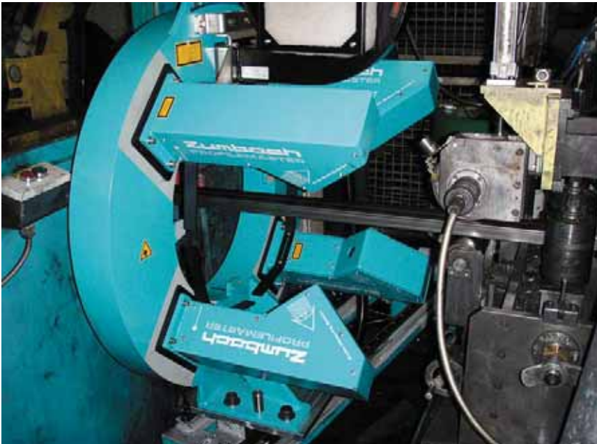
Измерительная система PROFILEMASTER SPS 140-N4 в линии холодного профилирования сварных труб
