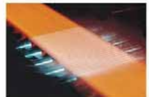
Система определения плоскостности полосы TopPlan Strip flatness measurement TopPlan
