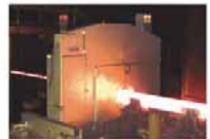
Система измерения толщины стенки труб Tube measurement
