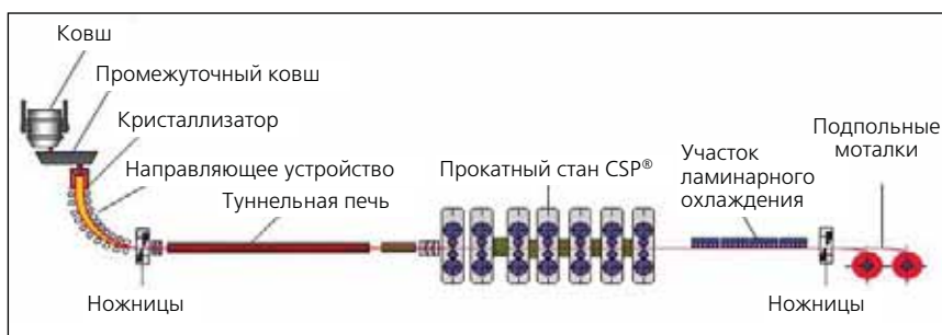
Рис. 5. Принципиальная схема CSP-агрегата
