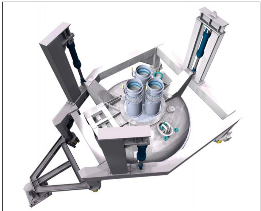
Рис. 2. Схема системы перемещения и подъема крышки вакуумной камеры
