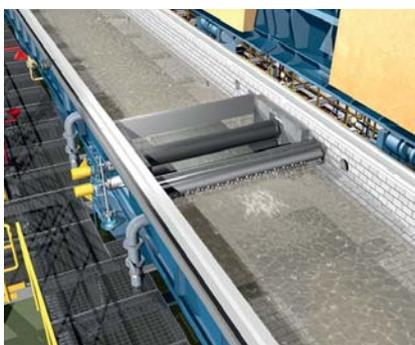
Рис. 7. Линия турбулентного кислотного травления
