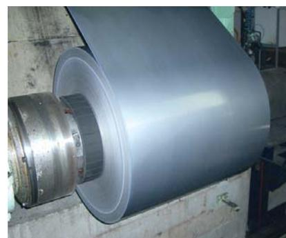
Рис. 8. Очищенная и обезуглероживанная полоса на сматывающей моталке
