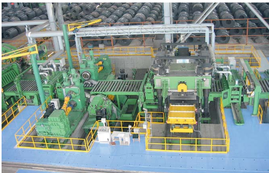
Рис. 2. Правильная машина в линии обработки прецизионных полос с кромкообрезными ножницами и кромкокрошителем
