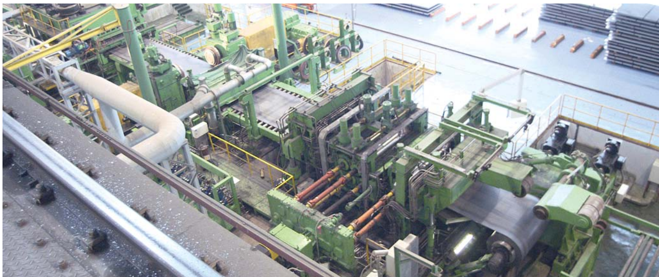
Рис. 1. Линия резки на мерные длины полосы толщиной до 25 мм в рулонах из углеродистых и коррозионностойких сталей
