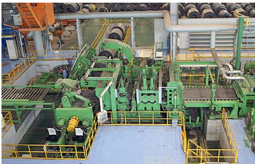
Рис. 5. Входной участок с разматывателем рулонов, машиной предварительной правки и ножницами для отрезки концов полосы
