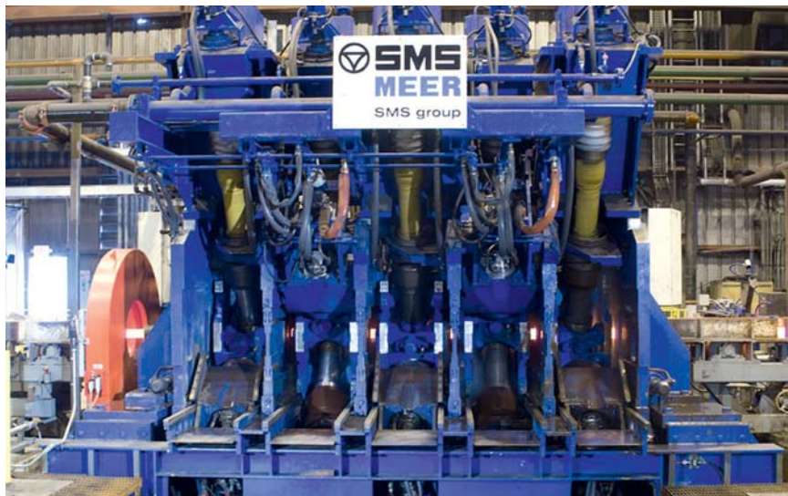
Рис. 1. Прецизионно-калибровочный стан PSM в действии
