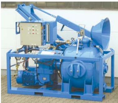
T115-1R с манипулятором ручного распыления или дизельной «пушкой» UELZENER 500 для горячего ремонта конвертеров или электродуговых печей
