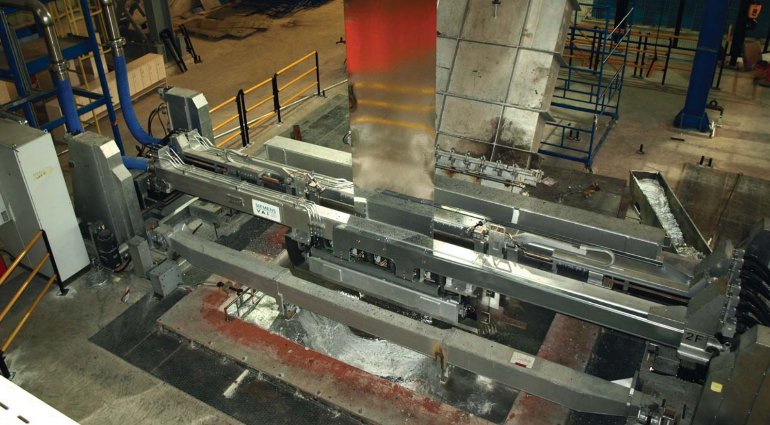
Рис. 3. Система DAK®E струйного регулирования покрытия в процессе горячего цинкования
