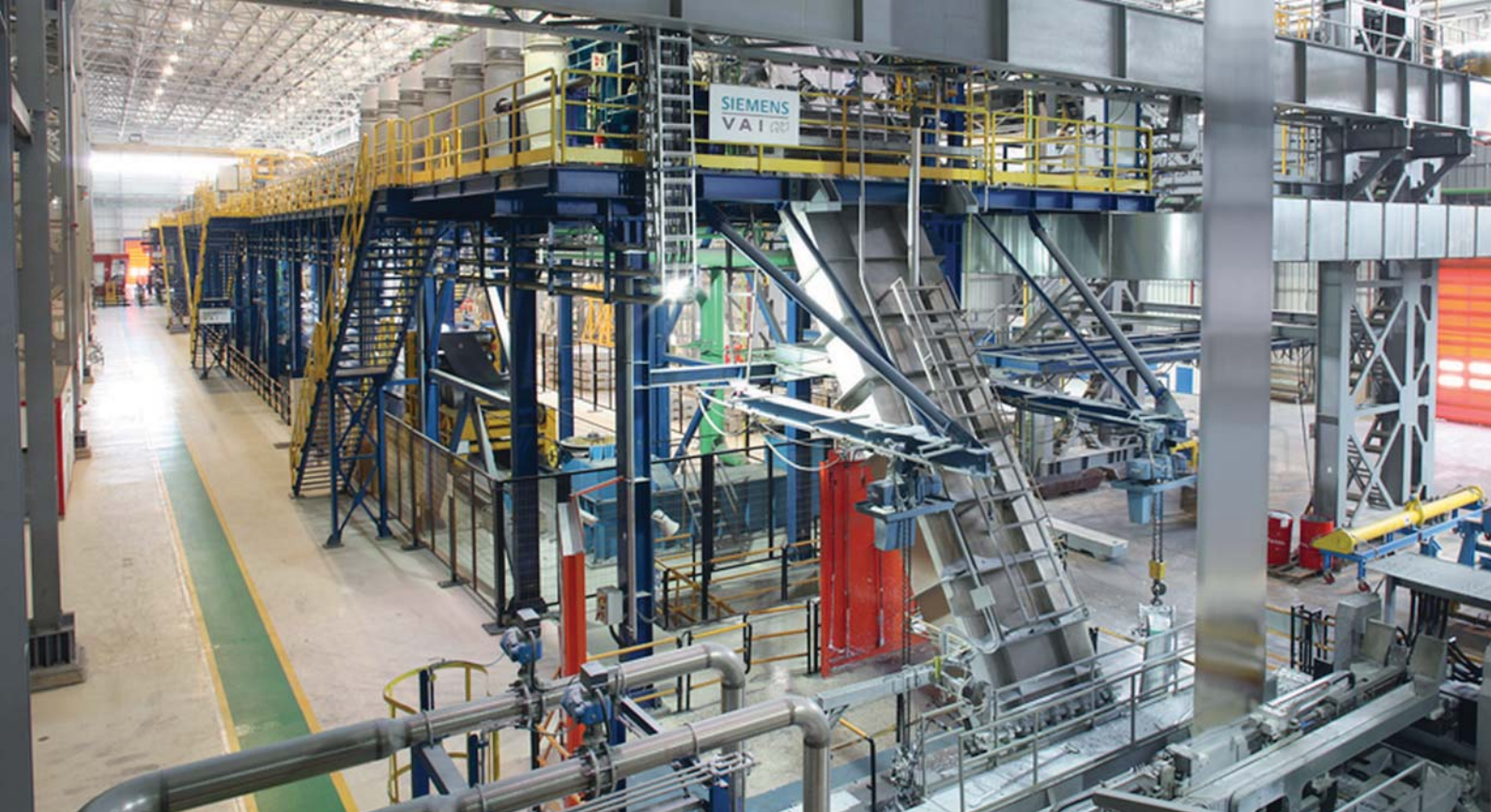
Рис. 2. Выходная сторона печи и участок ванны для цинкования
