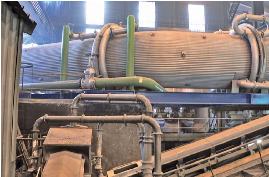
Газоход для горячих газов разделен на пять сегментов
