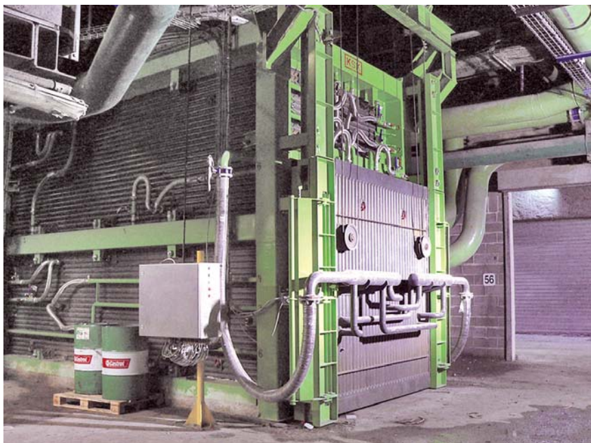
Подъемная дверца на фасаде камеры сгорания
