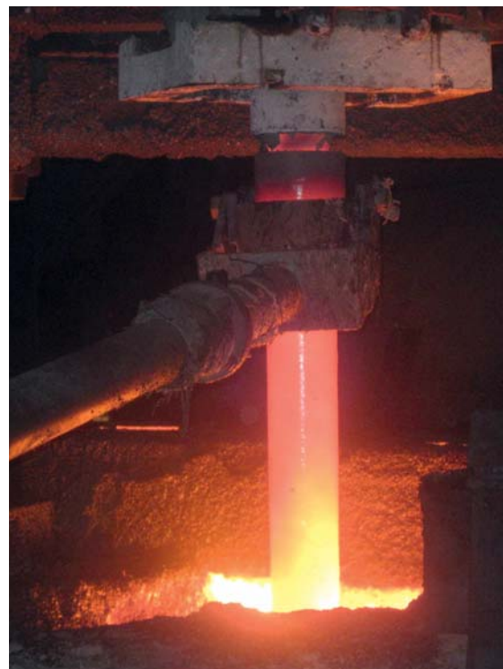
Манипулятор для установки защитной трубы в процессе работы
