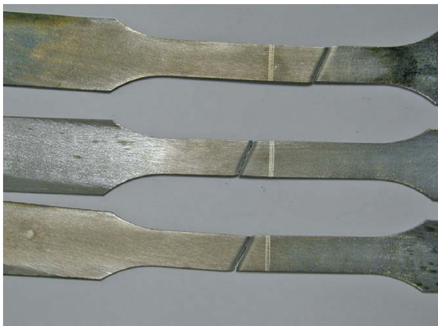
Образцы сварных соединений, полученных лазерной сваркой, после испытаний на растяжение
