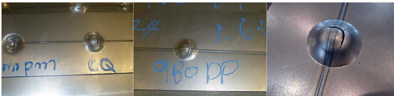
Образцы соединений, полученных методом лазерной сварки, после испытаний на твердость по Бринеллю
