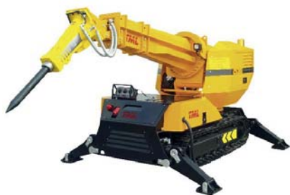
Новая машина UNIDACHS 220 компании TML Technik для ломки футеровки специально для использования на предприятиях черной металлургии
