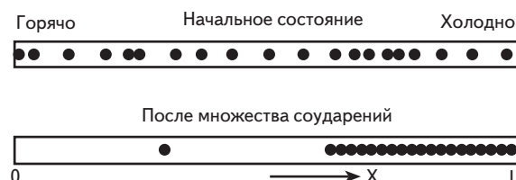
Рис. 5. Эволюция одномерной гранулярной системы
