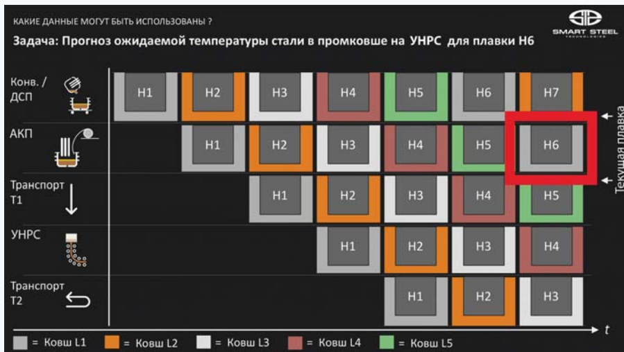
Рис. 2. Прогноз температуры стали в промежуточном ковше на УНРС для плавки Н6 в ковше L1 во время обработки этой плавки на АКП
