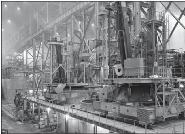
Рис. 2. Двухпозиционный VD-вакууматор № 1 на комбинате в Шанхае (Фото: sms mevac)
