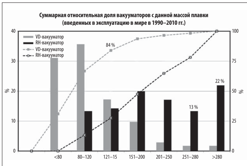
Рис. 3. Распределение вакууматоров по массе обрабатываемых плавков
