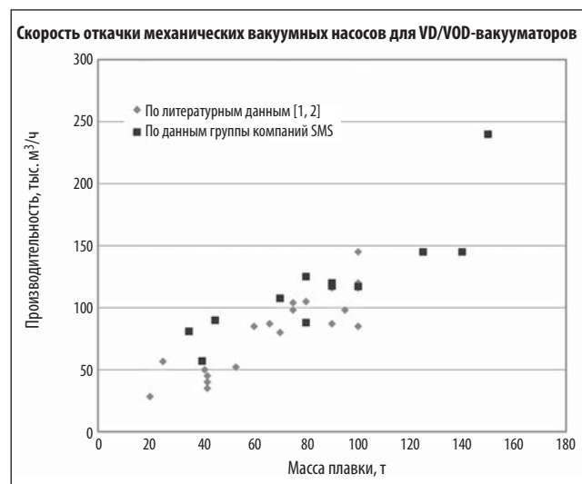
Рис. 5. Скорости откачки механических вакуумных насосов VD/VOD-вакууматоров, введенных в эксплуатацию в 2002–2012 гг.
