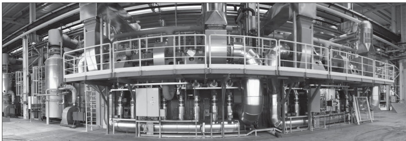
Рис. 9. Камерные кузнечные печи компании Böhler Edelstahl в Капфенберге
