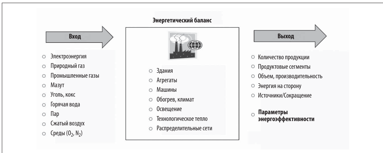
Рис. 4. Необходимые измерения для балансировки энергетических потоков
