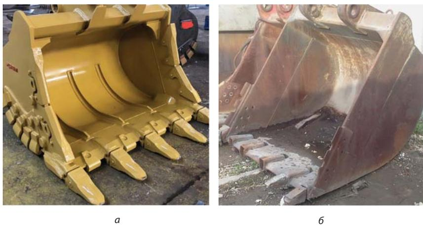
**Рис. 1.** Внешний вид ковшей карьерных экскаваторов до начала работы (а) и изношенные зубья ковша после эксплуатации (б)
