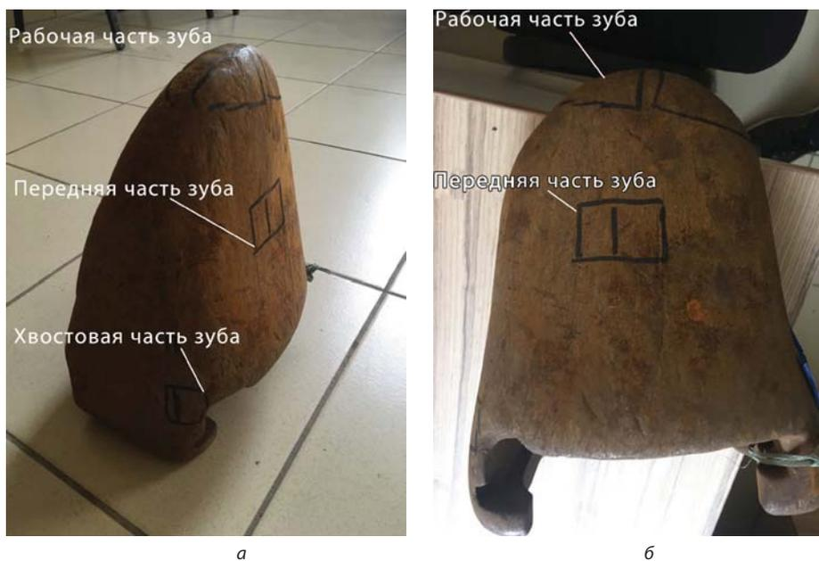
Рис. 2. Места вырезки образцов зубьев ковшей экскаваторов: а — вид сбоку; б — вид спереди
