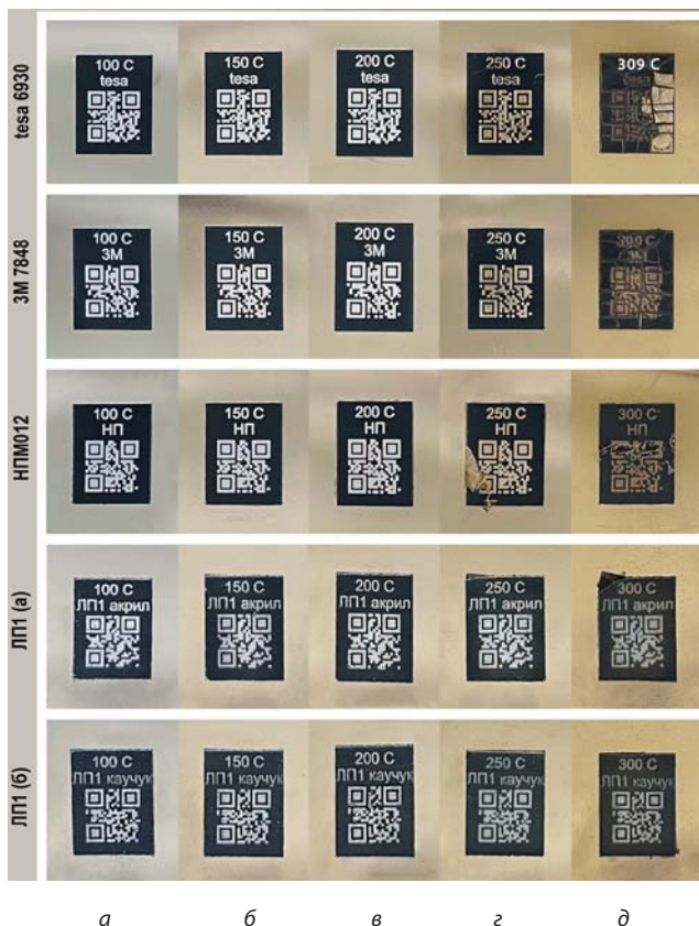
Рис. 2. Фотографии пленок tesa 6930, 3М 7848, НПМ012 и ЛП1 (ЛП 1а , ЛП 1б — с акриловым и каучуковым PSA-клеем соответственно), наклеенных на поверхности пластин из стали 10Х18Н9, после нагрева на 100 (а), 150 (б), 200 (в), 250 (г) и 300 (д) °С; размер QR-кода 10×10 мм
