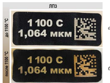
Рис. 4. Изображение маркировки на пленке ЛП3 до (а) и после (б) нагрева до температуры 1100 °С
