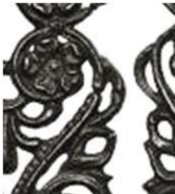
Рис. 2. Дефект на изделии, возникший из-за неполного заполнения металлом литейной формы
