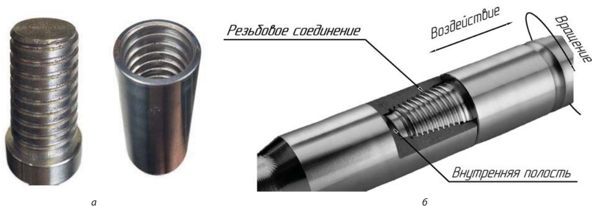
Рис. 1. Замковое соединение буровых труб: а — образцы; б — при эксплуатации
