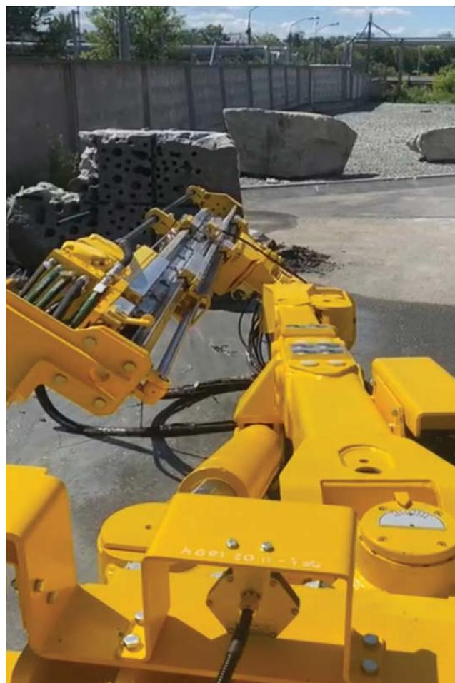
**Рис. 5. Тестирование гидравлического перфоратора на полигоне АО «МХ»**
