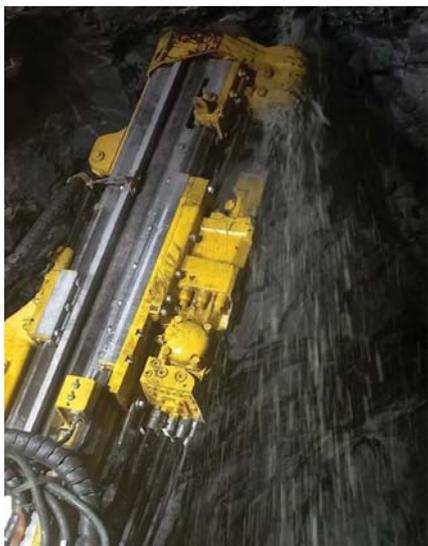
**Рис. 6. Ввод в эксплуатацию гидравлического перфоратора HLX5-MX на проходческой буровой установке DF-B1 в ОАО «ВГОК», г. Нижний Тагил**
