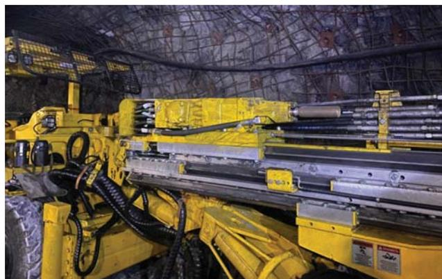
**Рис. 7. Ввод в эксплуатацию буровой установки DF-B1 с гидравлическим перфоратором HLX5-MX в АО «ЕВРАЗ ЗСМК» Казская шахта.**
