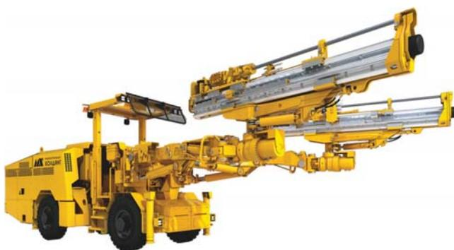
**Детализированная 3D-модель подземной гидроперфораторной буровой проходческой установки с двумя стрелами DF-C2**
