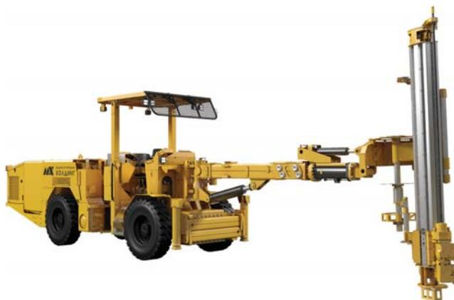
**Установка для механизированного монтажа анкерной крепи DR-B1**
