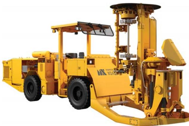
**Детализированная 3D-модель подземной гидроперфораторной установки очистного бурения DH-B1**
