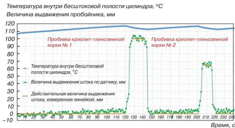
Рис. 9. Сравнение значений, зарегистрированных лазерным дальномером TOF200C-VL53L0X при нагреве до 120 °С с действительной величиной выдвигения штока пробойного устройства
