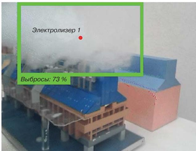
Рис. 6. Пример распознавания видимых выбросов вредных веществ на масштабных моделях электролизера с использованием обученной нейронной сети
