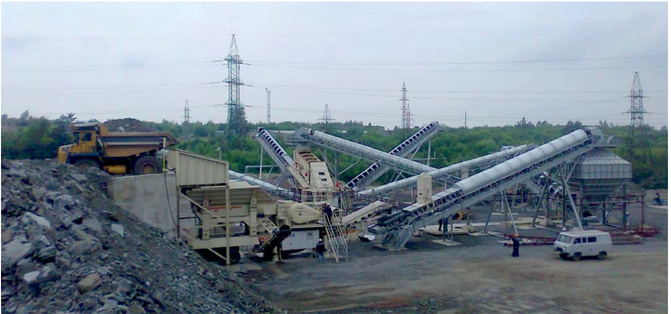
Рис. 3. Общий вид мобильного дробильно-сортировочного комплекса
