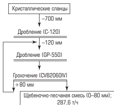
Рис. 2. Технологическая схема производства дорожного щебня на МДСК
