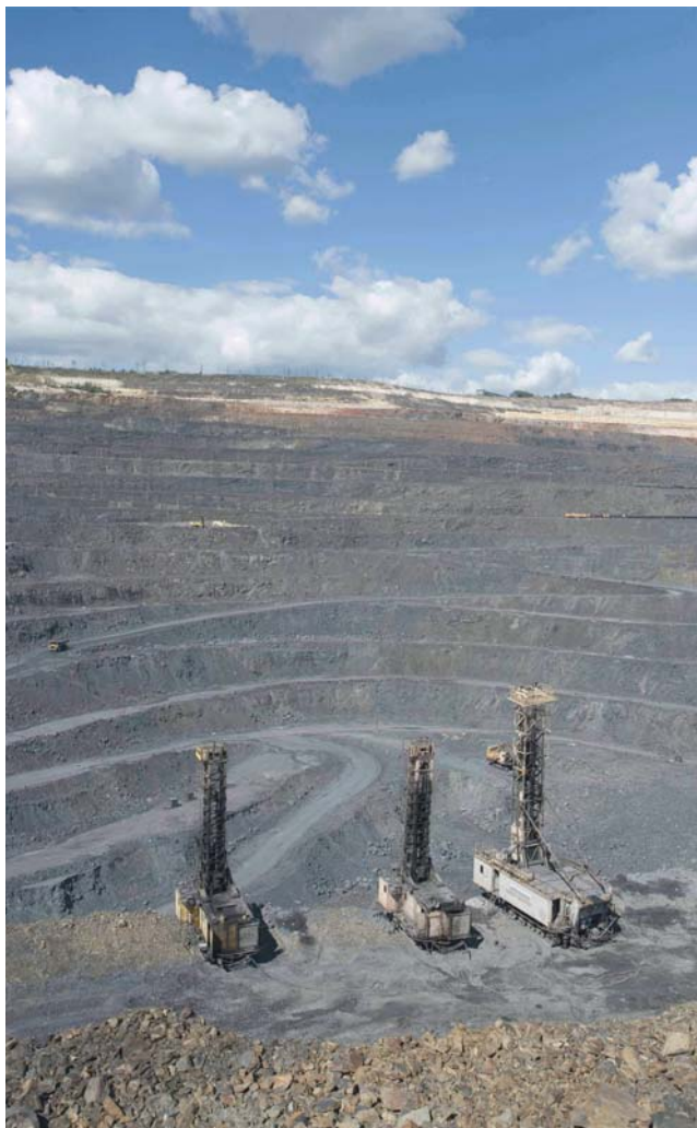
Процесс подготовки горных пород к выемке (бурение взрывных скважин)
