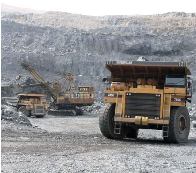
Процессы экскавации горной массы и ее транспортирования самосвалами
