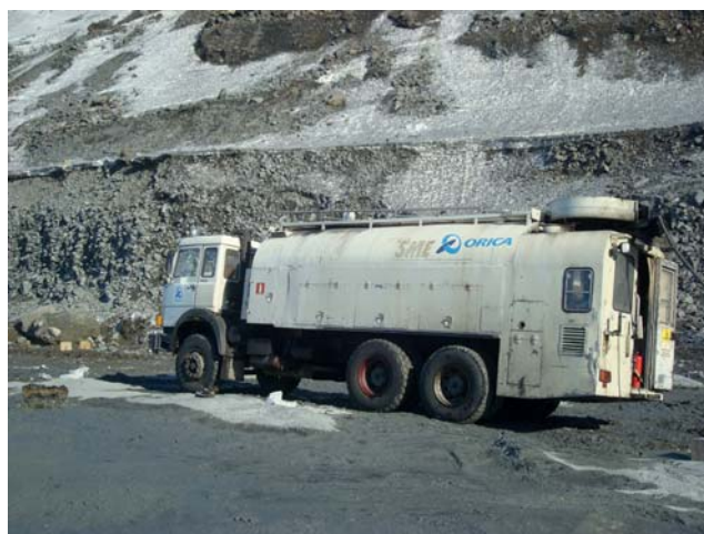
Смесительно-зарядная машина в карьере на зарядании скважин ЭВВ
