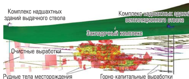
Рис. 3. Фрагмент технологической БД рудника в трехмерном представлении
