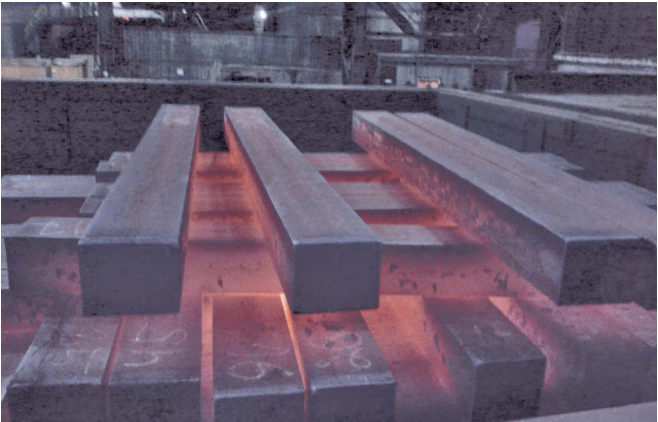
Блюмы, помещенные в колодец замедленного охлаждения
