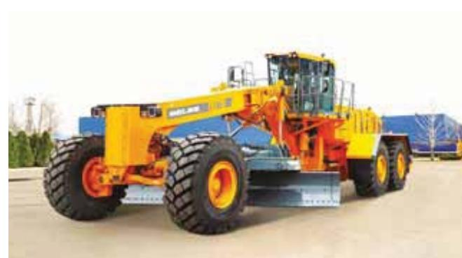
Грейдер оснащен комфортабельной кабиной, соответствующей всем стандартам безопасности. На сенсорном дисплее электронной панели приборов отображаются ключевые параметры работы машины, что позволяет быстрее обнаружить и устранить неисправность, а также значительно упрощает работу оператора. Большая площадь остекления кабины вкупе с современной системой видеонаблюдения предоставляет оператору полный обзор рабочей зоны, исключая «слепые зоны».
