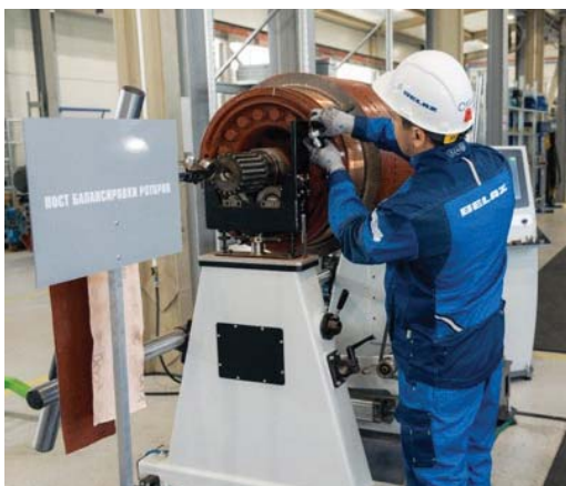
Балансировка ротора электрических машин после ремонта
