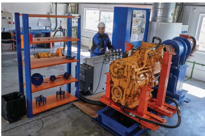
Испытания и обкатка гидромеханической передачи после ремонта
