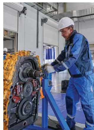
Ремонт гидромеханической передачи
