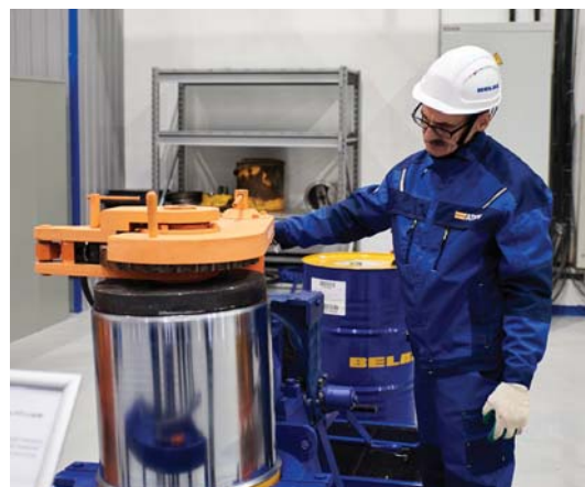
Ремонт цилиндра подвески
