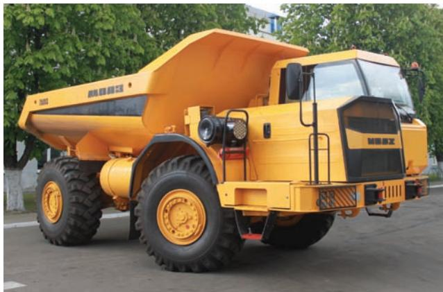
МоАЗ-75053 грузоподъемностью 25 тонн оснащен 380-сильным дизельным двигателем, жесткой высокопрочной рамой и предназначен для перевозки насыпных грузов как по технологическим дорогам, так и по бездорожью в горнодобывающей и строительной отраслях.
